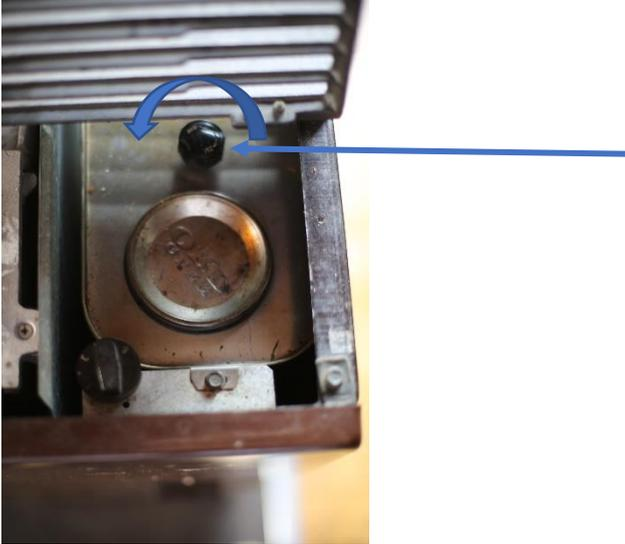
5. Puis mettre le robinet de réglage de puissance du chauffage sur 1-2 au départ, monter plus haut si besoin
