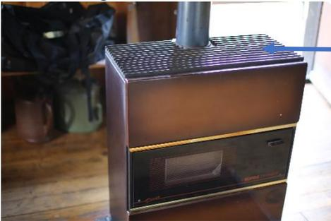
3. Soulever le bouchon du réservoir et vérifier si le niveau se trouve à environ 2 cm du haut (si ce n'est pas le cas procéder au remplissage du réservoir)
