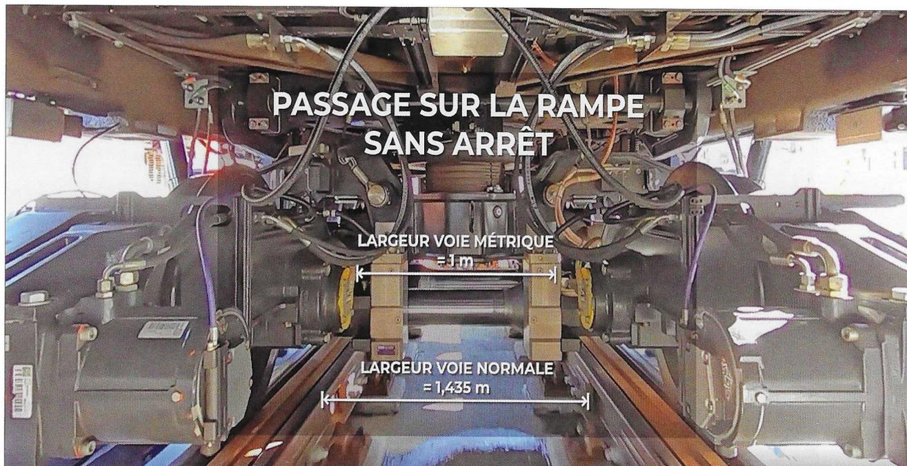
Le bogie à écartement variable qui, placé sous le train, permet de passer de la voie étroite à la voie normale, présenté en 2022.
